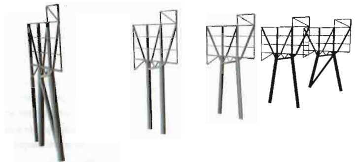
De kolommen staan nu schuin. Samen met de dwarsvakwerken vormen die de 'vliegenmeppers'.
